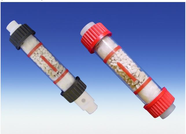
Los filtros de absorción pueden retirar componentes nocivos (como NH3) del gas de medición. En muchos casos es recién posible una preparación confiable y un análisis del gas de medición cuando se han retirado todas las substancias perturbadoras del gas de medición. Hay a disposición materiales de filtros apropiados para los diferentes componentes del gas que eliminan los componentes respectivos del gas de medición de forma confiable y selectiva.
